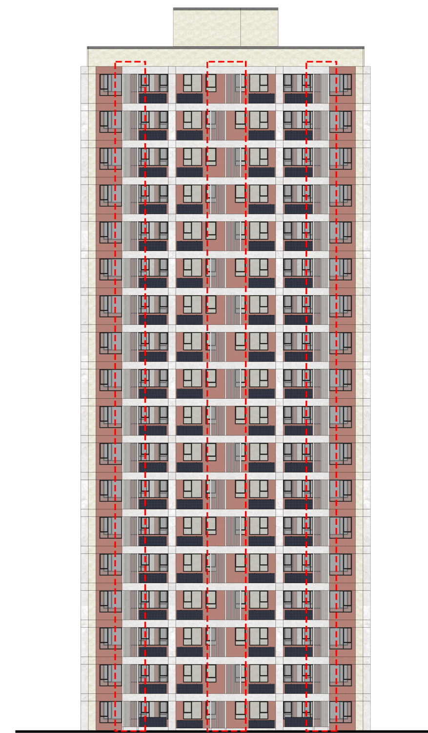
2、加入格栅构件，实现立面可变
