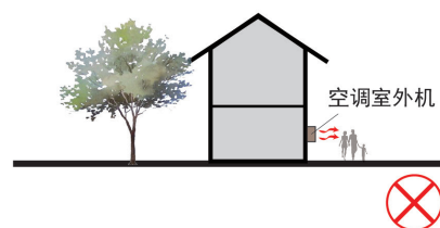
空调外机面向公共人行道
